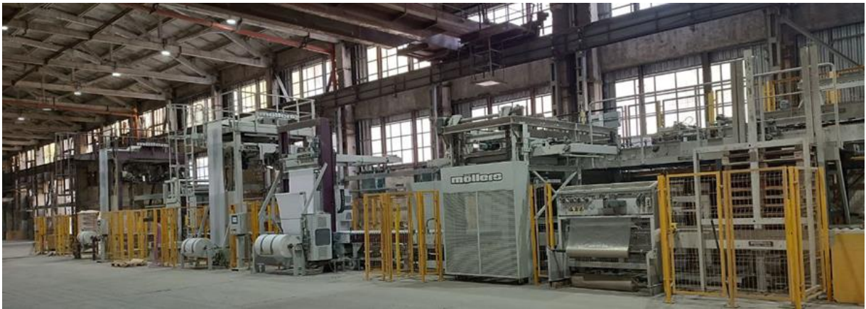
Рис. 1. Технологическая линия упаковки цемента на поддонах и в мягкой упаковке
