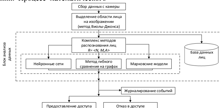
Рис. 2. Структура работы программного комплекса распознавания лица
