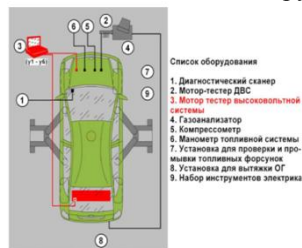
Рис. 1. Схема поста диагностики гибридного автомобиля
