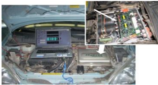
Рис. 2. Контроль силы тока в шине постоянного тока инвертора
